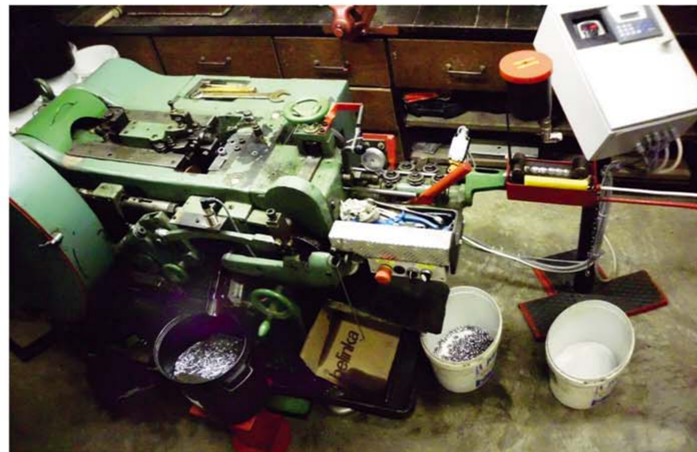
Eine der verwendeten Maschinen bei der Firma LOS zum Pressen der Geschosse aus dem angelieferten Bleidraht.
