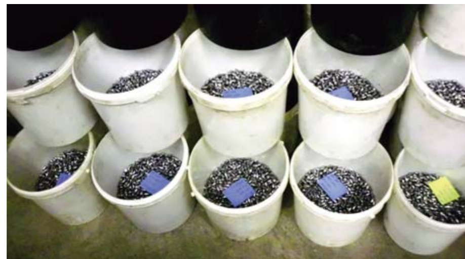
Die gepressten Geschosse warten auf ihr Galvanikbad, was ihnen die ersehnte Kupferschicht bringt.
